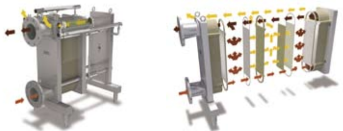
Durchflussmuster in einer Plattenrahmen-Einheit. Rot bedeutet Zufuhr/Retentat. Gelb bedeutet Permeat.
