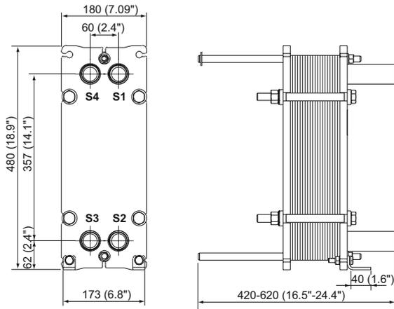
Die Anzahl der Spannbolzen kann je nach Druckauslegung variieren.
