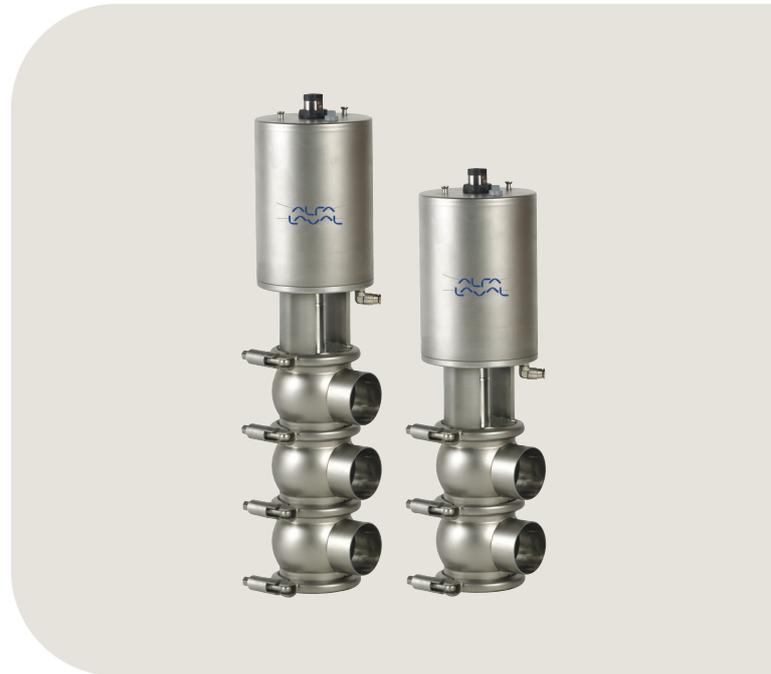
Ventildichtungen sind durch eine definierte Verpressung auf Haltbarkeit und lange Lebensdauer optimiert. Der Stellantrieb ist über einen Haltebügel mit dem Ventilgehäuse verbunden. Sämtliche Teile werden mit Spannringsen zusammengehalten.
